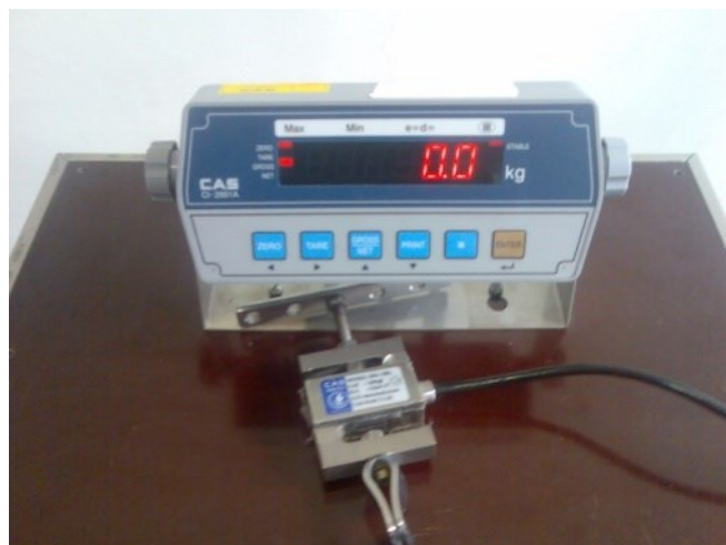
Рис. 3. Пристрій для реєстрації величини навантаження CAS типу CI-2001A з тензометричним датчиком SBA-100L.
